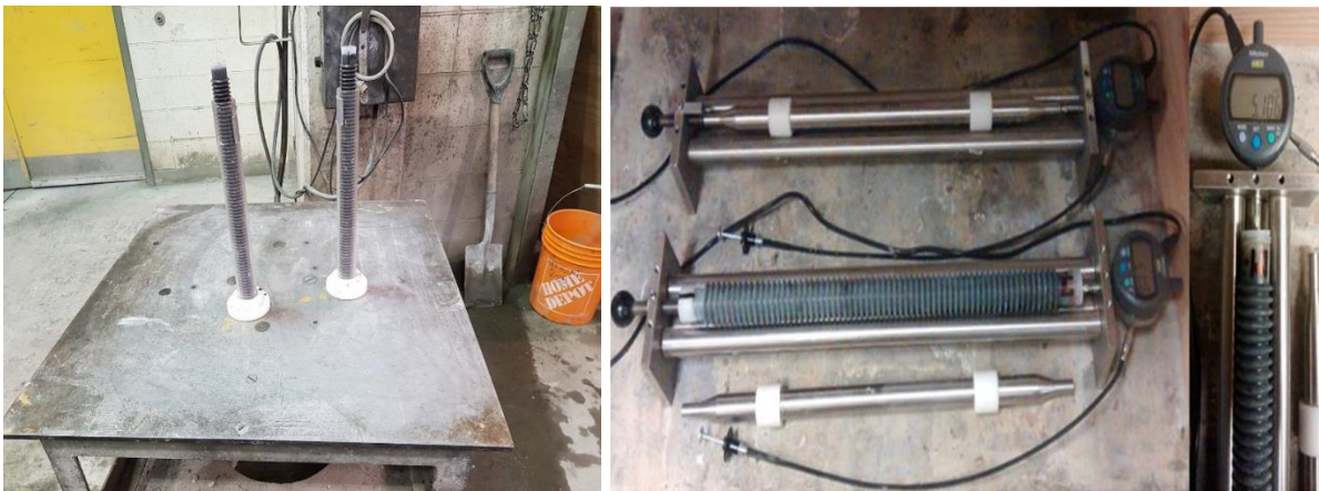
Figure 2-24 : a) Remplissage du moule ondulé et b) Mesure du retrait endogène
