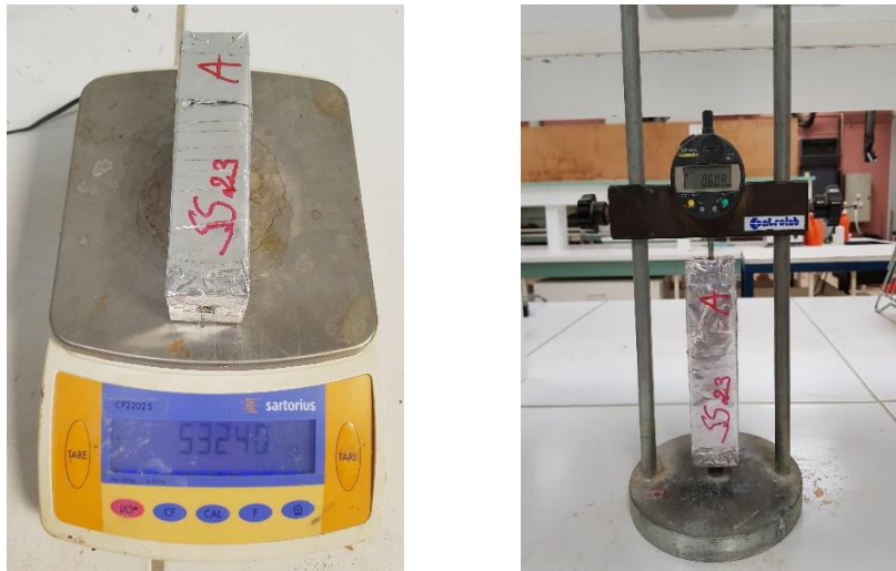
Figure 2-28 : Mesure de la perte de masse (à gauche) et du retrait (à droite) (protocole 2)
