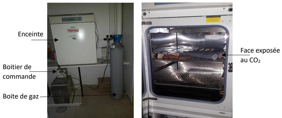
Figure 2-32 : Schéma et photographie du dispositif de carbonatation accélérée
