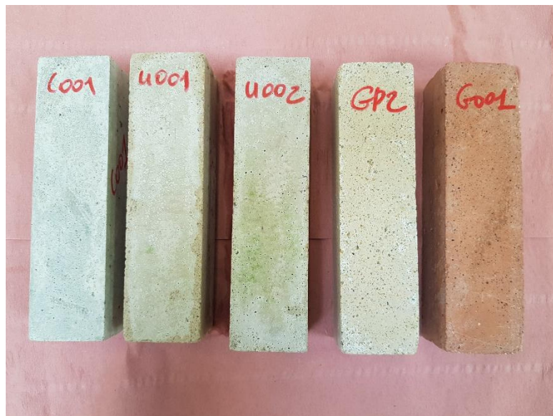
Figure 4-19 : Aspect visuel des mortiers C001, U001, U002, GP2 et G001 au cours des cycles de gel dans l'air et dégel dans l'eau
