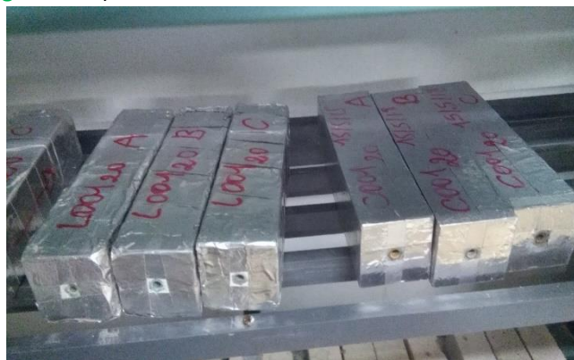
Figure 2-27 : Échantillons scellés uniquement avec du papier d'aluminium (Protocole 2)
