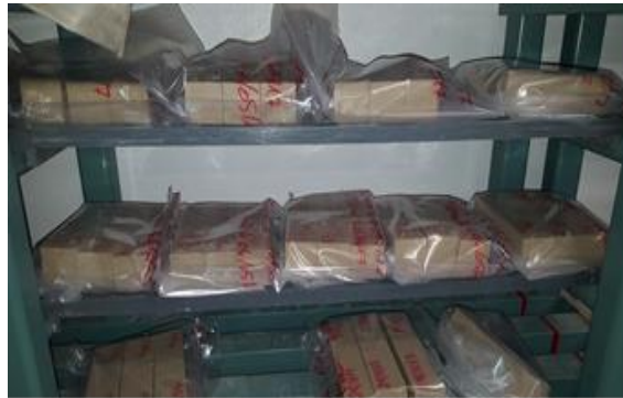
Figure 2-25 : Échantillons conservés dans des sacs étanches (Protocole 1)
