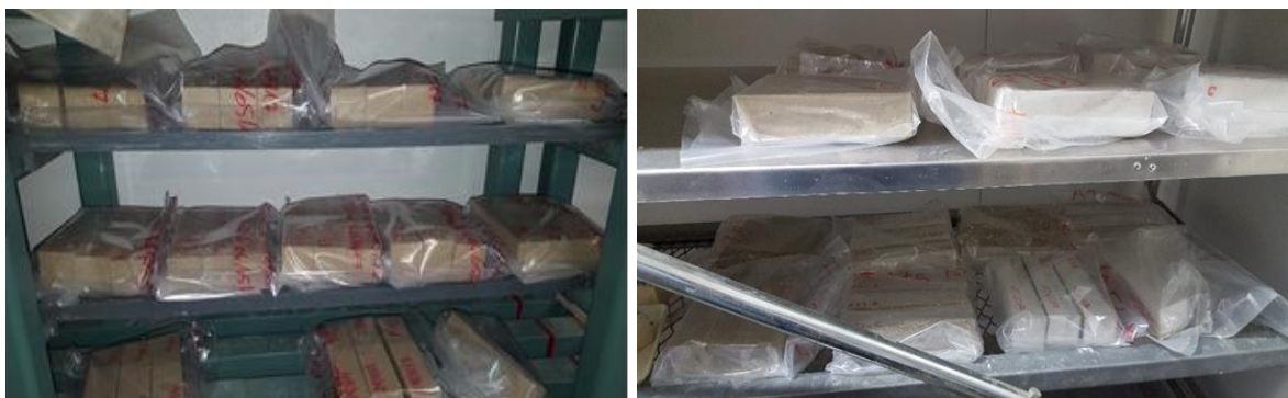
Figure 2-5 : Conservation des éprouvettes alcali activés dans les salles humide (à gauche) et sèche (à droite)
