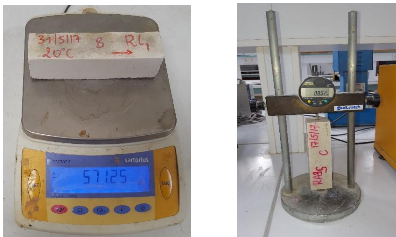
Figure 2-26 : Mesure de la perte de masse (à gauche) et du retrait (à droite) (protocole 1)
