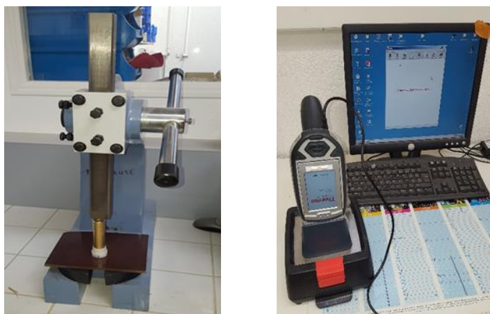
Figure 2-6 : a) Presse de pastillage et b) Analyseur FX Niton XL3t XFR (à droite)
