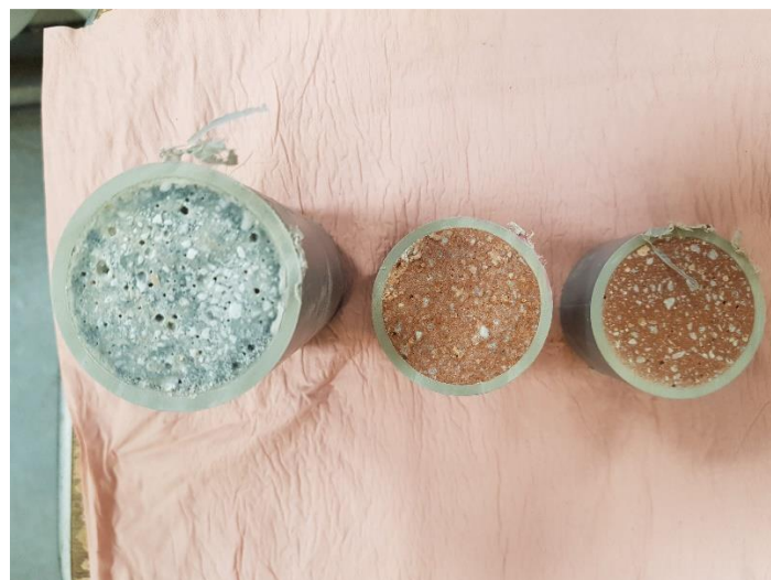
Figure 4-10 : Apparition d'efflorescences à 120 jours de carbonatation accélérée
