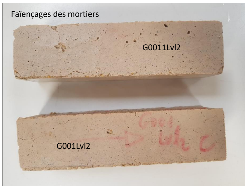
Figure 4-25 : Observation visuelle de la surface des échantillons après 100 jours d'immersion
