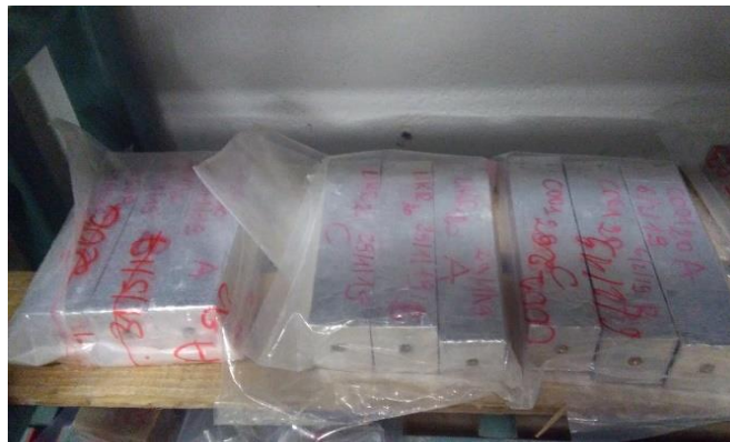
Figure 2-29 : Echantillons scellés avec du papier d'aluminium et introduits dans des sacs étanches (Protocole 3)
