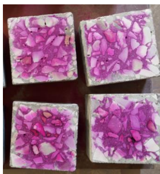
Figure 1-32 : Exemple d'essai à la phénolphtaléine (Merah et Krobb, 2017)
