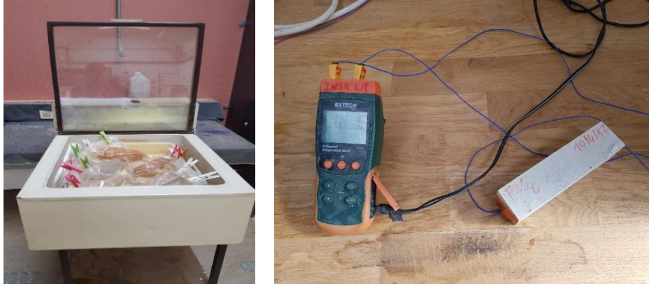
Figure 2-35 : a) Essai de gel et b) Préparation de l'éprouvette avec le thermocouple
