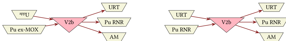
FIGURE 6.7 – Illustration du cycle modélisé des RNR-Na pendant la phase transitoire (à gauche) et à l'équilibre (à droite)
