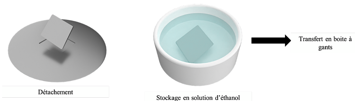
Figure 5-2 Schéma illustrant le détachement et le transfert de la couche poreuse vers la boîte à gants
