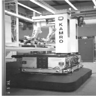
Figure 1.2 – Le manipulateur mobile KAMRO, en milieu industriel
