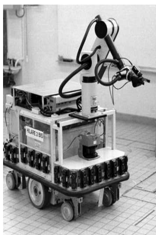
Figure 6.1 – Manipulateur mobile du LAAS
