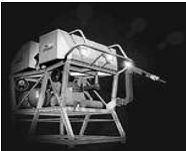
Figure 1.3 – Le robot sous-marin téléopéré VICTOR 6000
