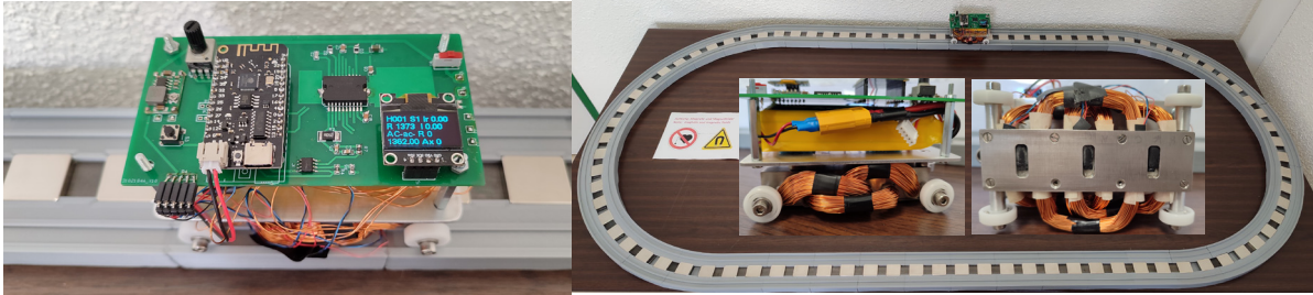
Figure 9. Moteur linéaire BLDC et son circuit fermé d'aimants permanents
