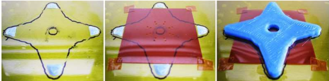
Figure 3.9 : Photographies des différentes étapes du procédé d'impression de la partie rigide en PLA du capteur de pression sur la membrane en polyimide.
