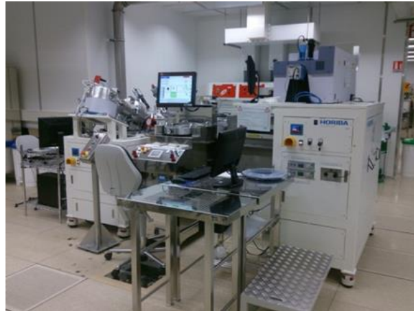
Figure 107 - Plateforme expérimentale Impact avec ellipsomètre (gauche) et une chambre spectromètre Raman/Photoluminescence (droite).
