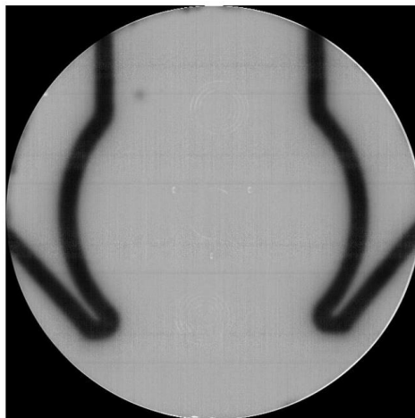
Figure 29 - Cartographie de MPL montrant des marques caractéristiques de supports de mesure induisant de la défektivité en face arrière détectée par la chute du signal BAB.
