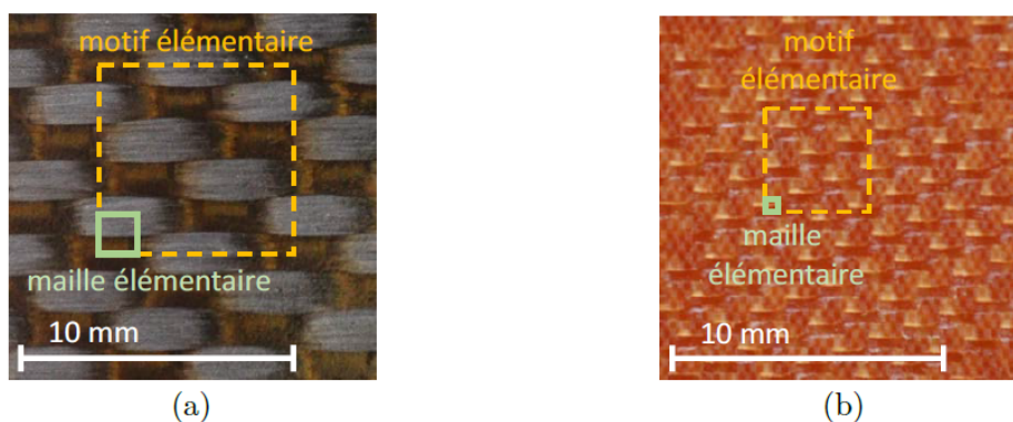
FIGURE 2.3 – Matériaux composites utilisés : tissus (a) carbone/époxy et (b) verre/époxy
