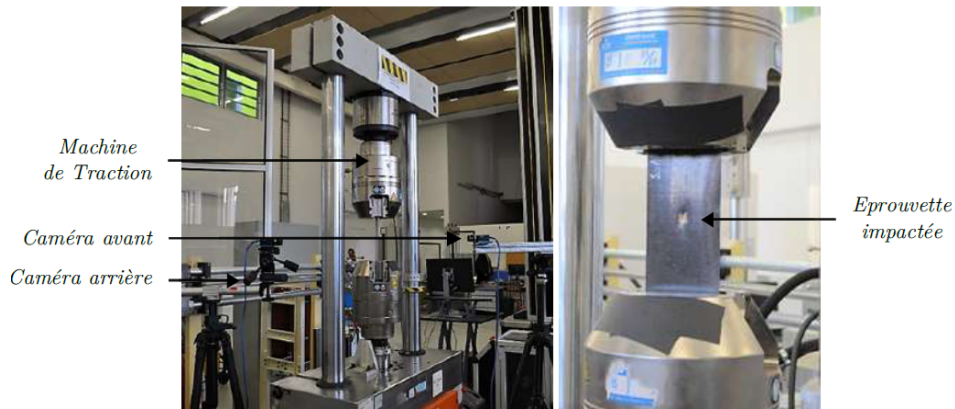
FIGURE 2.36 – Conditions expérimentales de l'essai de traction quasi-statique sur éprouvette impactée
