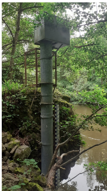
Figure 4.2 – Échelle limnimétrique du réseau Vigicrues installée sur l'Allier (Prades, Haute-Loire, 2024) (c) Gondran N.
