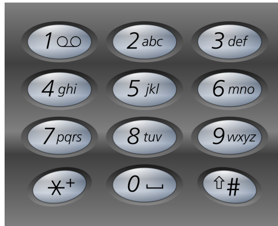
FIGURE 1.9 – Illustration d'un clavier 3*4 de téléphone mobile physique. Chaque touche correspond à plusieurs commandes possibles.
