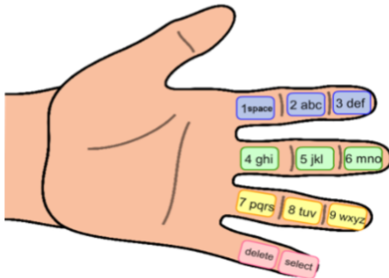
FIGURE 1.55 – Schéma représentant le dispositif FingerT9 de Wong et al. (2018). Illustration issue de [242].
