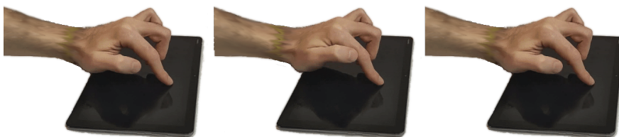
FIGURE 2.2 – Un TAP effectué sur l'index lorsque celui-ci est en contact avec l'écran tactile.
