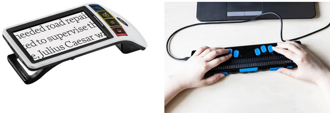
FIGURE A.2 – Gauche : Loupe électronique (aussi appelée “loupe vidéo”). Droite : Clavier Perkins permettant d’écrire et de lire en Braille sur ordinateur.
