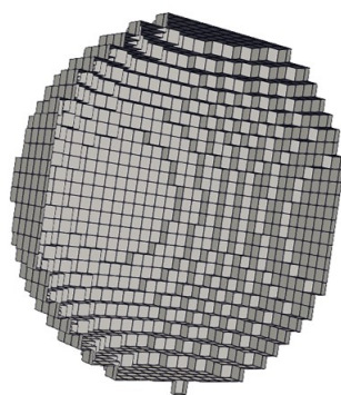
FIGURE 2.7 : Coupe d'un maillage surfacique cartésien d'une sphère.
