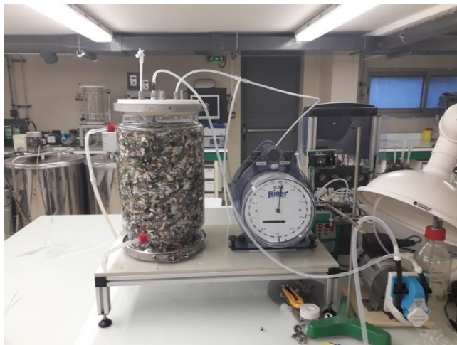
Figure 14 : Schéma et photographie du pilote de percolation. Source A. Vignes
