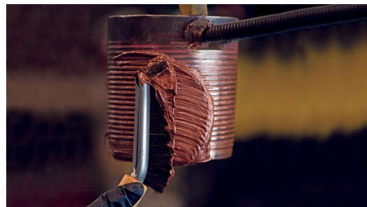
Figure 1-16 Illustration d'une graisse appliquée à la brosse sur une connexion [61]
