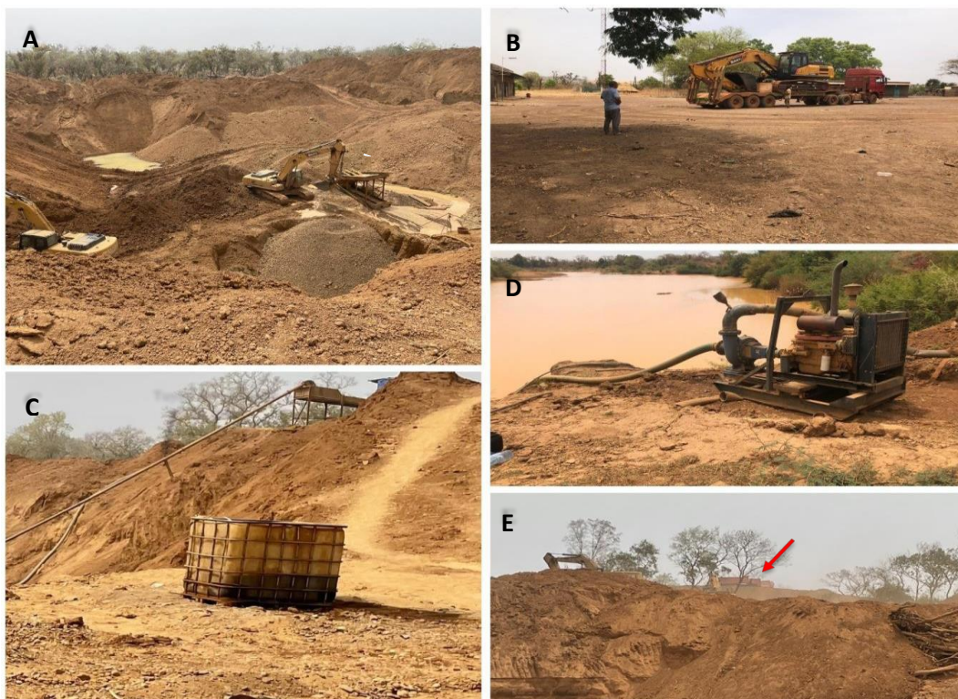
Figure 43 : Équipements utilisés dans l'exploitation minière semi-mécanique par les mineurs chinois (Photos : G. Arnaud-Fassetta et E. H. S. Top, Février et Avril 2023).
