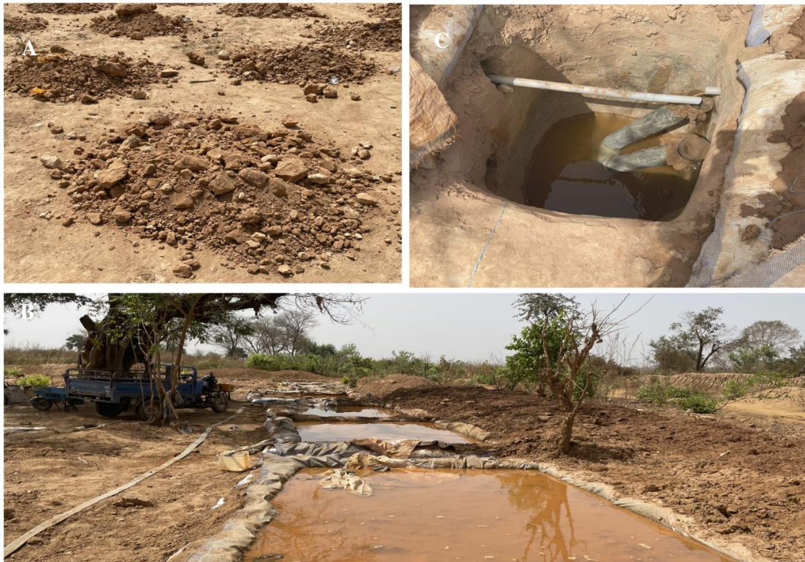
Figure 32 : Procédé de traitement des minerais d'or dans un bassin de cyanuration (photos : G. Arnaud-Fassetta, février 2023).
