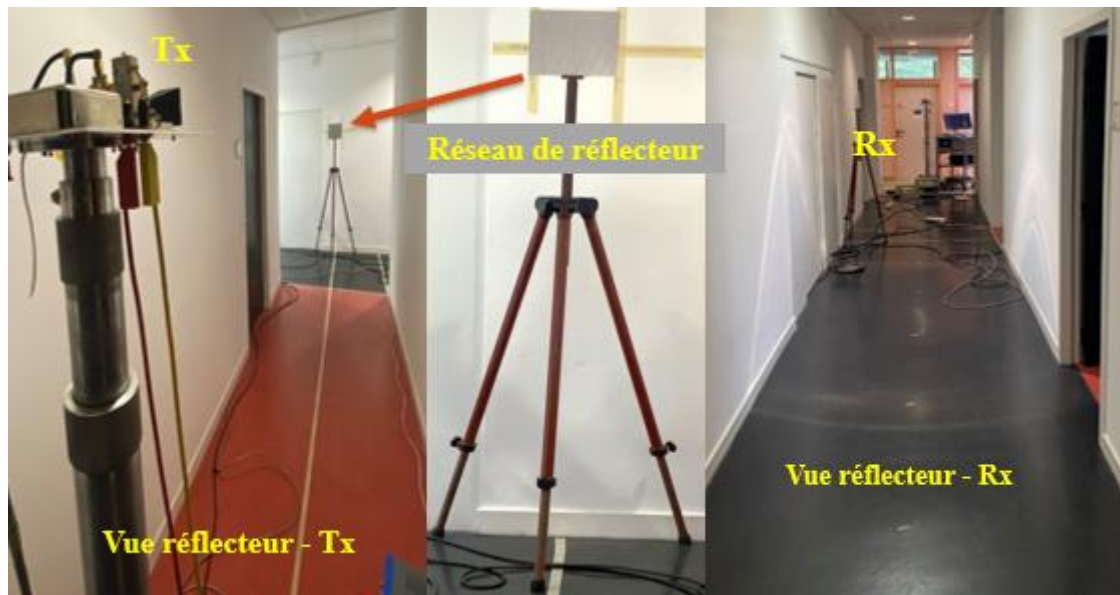
Fig. 5.18. Scénario de mesure du couloir en T
