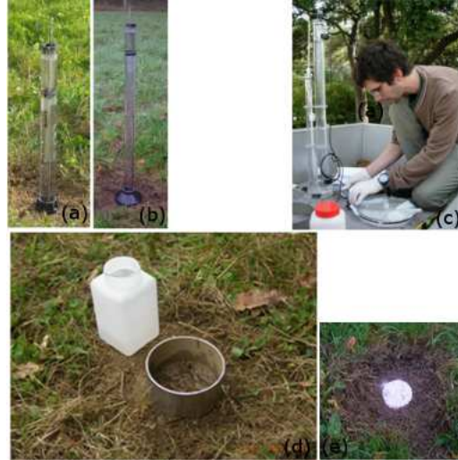
Figure 5.1: Dispositif d'infiltration : infiltromètres minidisques de diamètre 4.5 cm (a) et 8 cm (b), infiltromètre SW080 (SDEC), essai Beerkan (d), préparation du sol avec sable de contact pour essais avec infiltromètres (e)
