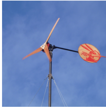
(b) Eolienne Piggott. Source : Tripalium.
