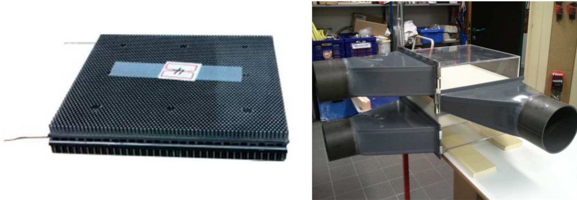
Figure 3.16. Démonstrateur assemblé (modules thermoélectriques et ailettes à gauche ; démonstrateur complet à droite)
