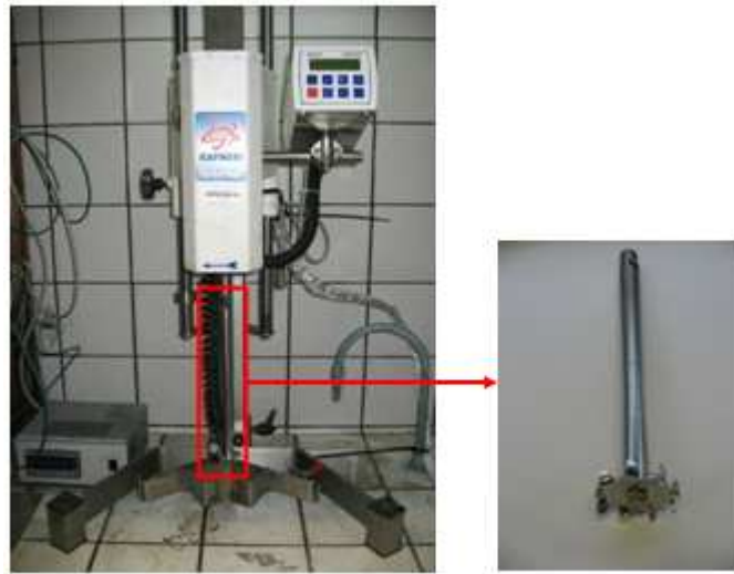
Figure 2-2 : Photographie du mélangeur Rayneri et de l'hélice utilisée
