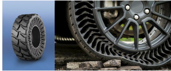
FIGURE 5.2 – Exemple de structure porteuse : le pneu Michelin Tweel
