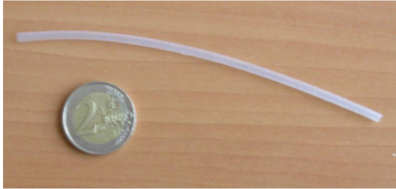
figure 75 : Tube extrudé de P(VDF-TrFE-CFE) avec 15%wt de DINP
