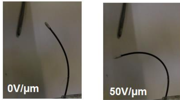
figure 78 : Photographie du prototype de fil guide pour deux niveaux d'excitation électrique
