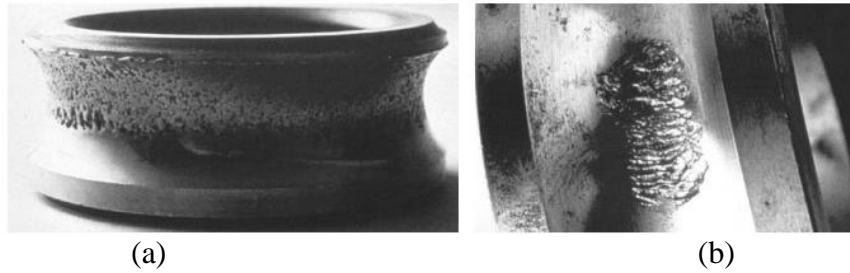
figure 103 : Dégradation de chemins de roulement dues à des surcharges mécaniques (extrait de [99]), (a) Aspect de la bague interne d'un roulement sur-charge, (b) Ecaillage d'une piste de roulement
