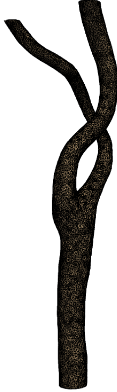
Figure 2.1: Maillage du vaisseau utilisé pour les simulations.
