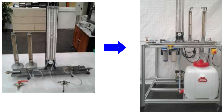
FIGURE 5 – Rénovation d’un banc de TP illustrant l’influence du régime d’écoulement sur les pertes de charge rencontrées dans une conduite cylindrique de grand allongement.
