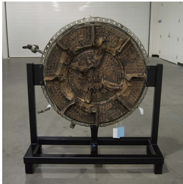
FIGURE 1.7. – Fond de chambre d'un des moteurs F1 de la Saturn V d'Apollo 11 après le vol
