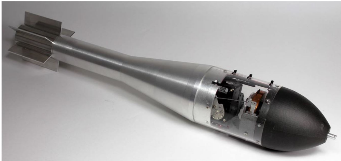
FIGURE 0.10 – Prototype de projectile guidé équipé d'un actionneur gyroscopique interne [Rou23]
