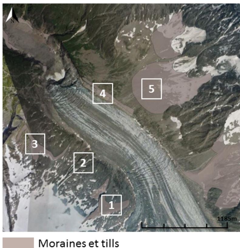
FIGURE II.8 – Cartographie des tills et moraines obtenue lors du projet GlaRiskAlp. Les zones potentiellement sensibles aux déformations ont été numérotées et décrites dans les figures II.9 et II.10.
