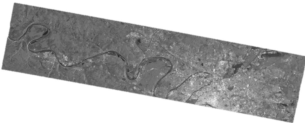
FIGURE III.11 – Moyenne temporelle des intensités de la pile descendante construite à partir d'un seul burst (05/03/2016-30/06/2019). L'image ortho-rectifiée montre qu'un seul burst permet de surveiller la partie située au Nord de la Seine ainsi que les méandres de la Seine à l'Ouest, soit l'intégralité du tracé du projet EOLE.
