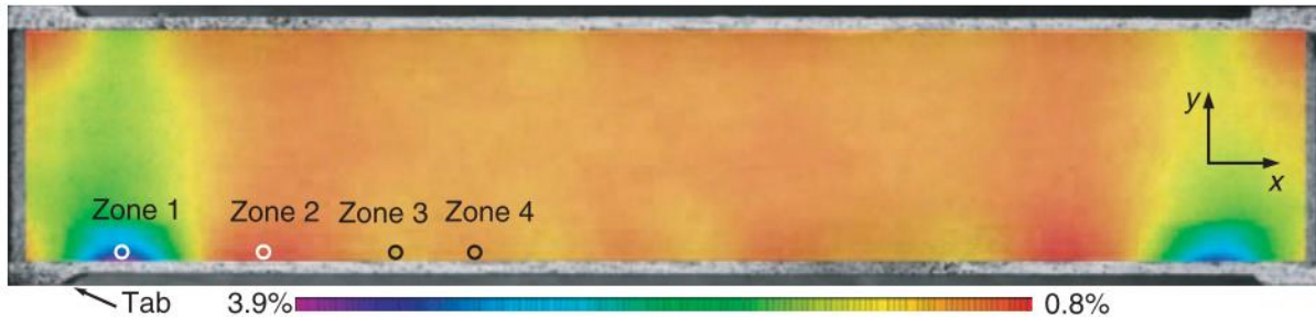
Figure 43 : champs de déformations dans l’âme d’une éprouvette coupon sandwich mesurée par corrélation d’image. (Koissin et al., 2010)
