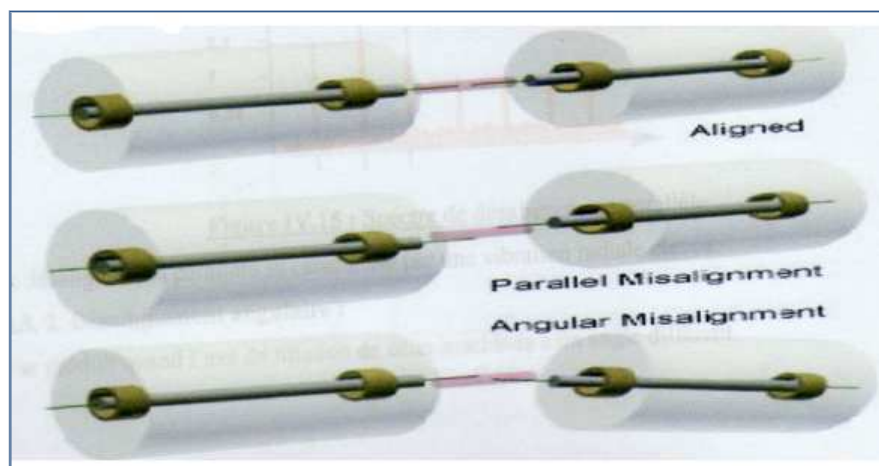
Figure 2.11 Désalignement des arbres.
