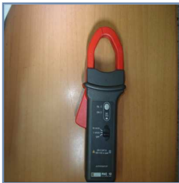
Figure 4.17 Matériel de Captage des signaux vibratoire et courant
