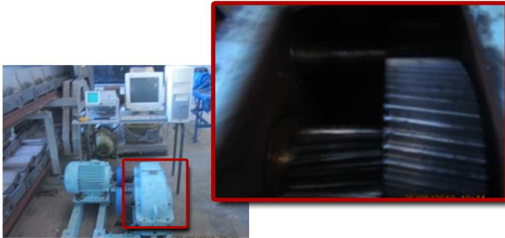
Figure 4.21 Banc d'essai du Système d'entraînement électromécanique.
