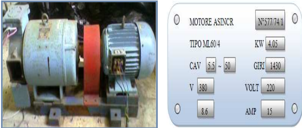
Figure 4.18 Photo du deuxième agrégat dédié au diagnostic des défauts mécaniques.
