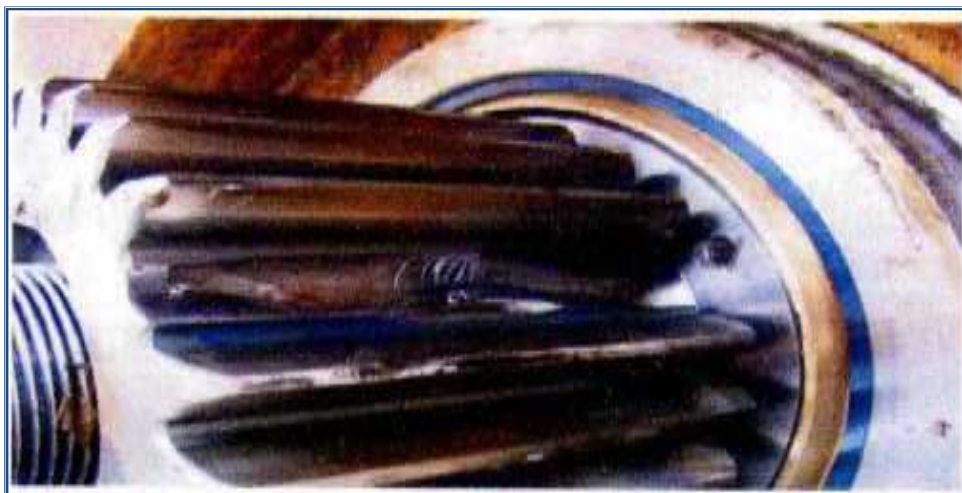
Figure 2.17 Défauts réels d'engrenage localisés.
