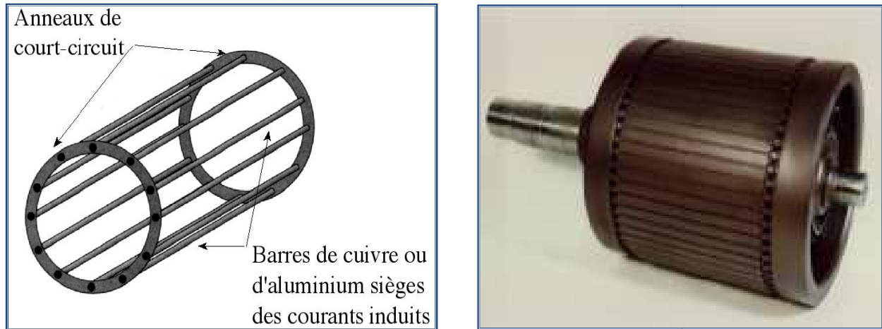
Figure 1.4 Représentation schématique du rotor à cage
