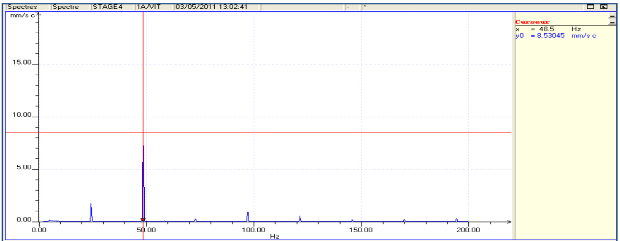
Figure 5.3 Moteur en Présence du Défaut de Désalignement Angulaire.
