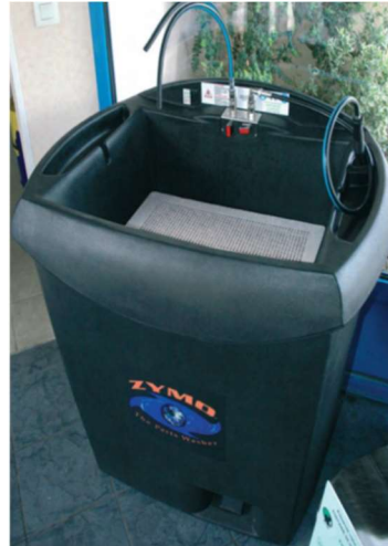
Figure 5. Fontaine de dégraissage à solvant (à gauche) et fontaine de biodégradation des graisses (à droite).
