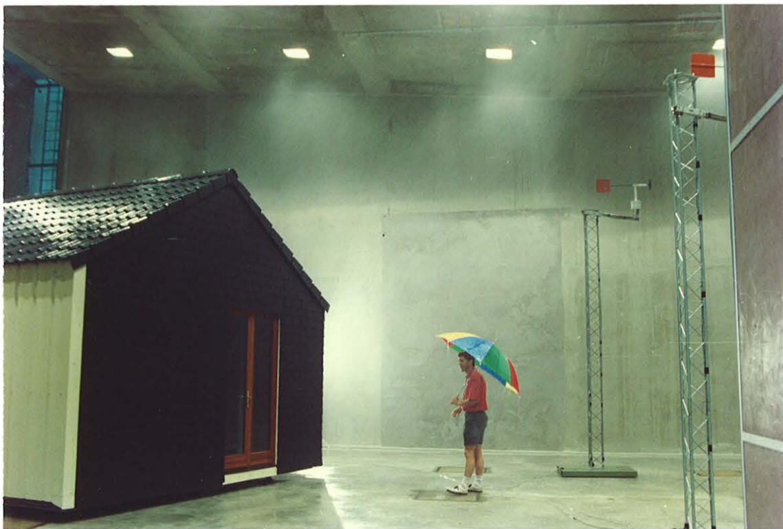
Figure 4 : La veine environnement - tests d'étanchéité à l'eau.
