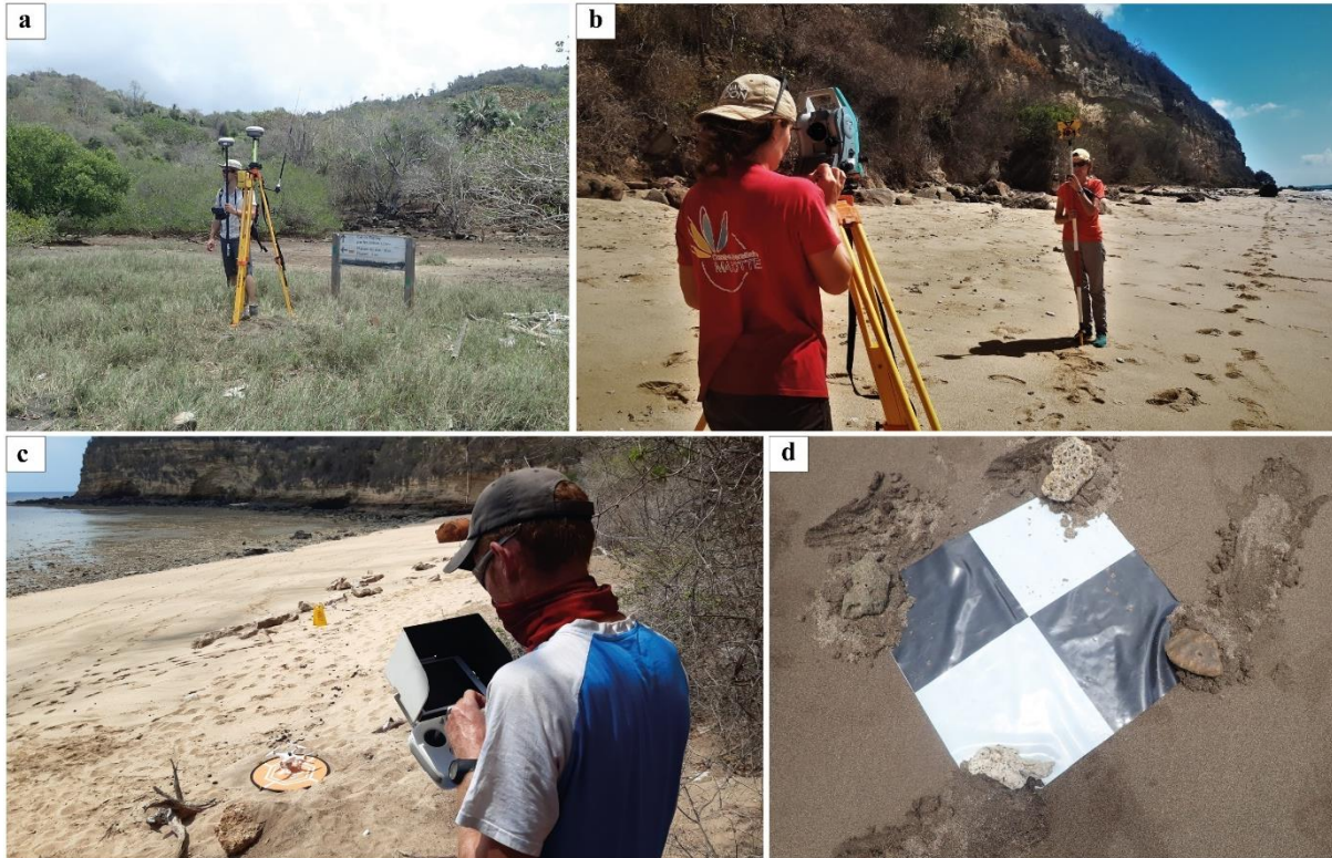
Figure.2.4. Photographies des divers appareils utilisés pour mesurer l'évolution de la morphologie des plages de Grande Saziley et Papani. a) Récepteurs de base et mobile du GNSS-RTK Trimble 8s, b) prise d'un point de coordonnées géographiques avec une station totale Nikon XF, c) drone DJI Phantom 4 Pro, d) cible mise en place comme point de calage pour la reconstruction photogrammétrique des images de drone. Clichés S. Morisseau.
