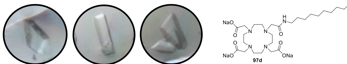
Figure 27. Expériences de cristallisation de BmrA en présence du détergent 97d et cristaux obtenus.
