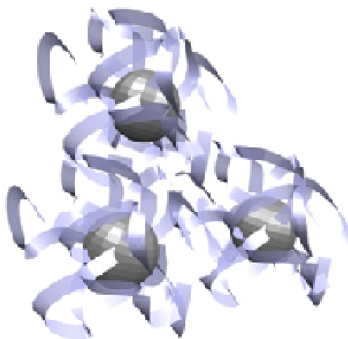
Figure I.24. Schéma de stabilisation de NPs par des polymères.
