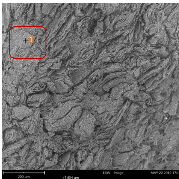
Figure IV - 7 : Micrographie MEB de la surface d'une électrode de Graphite après 1800 s d'électrolyse à I = 240 mA dans LiF/CaF_2/Li_3N ( 0,1 \text{ mol kg}^{-1} ) à 850^\circ C
