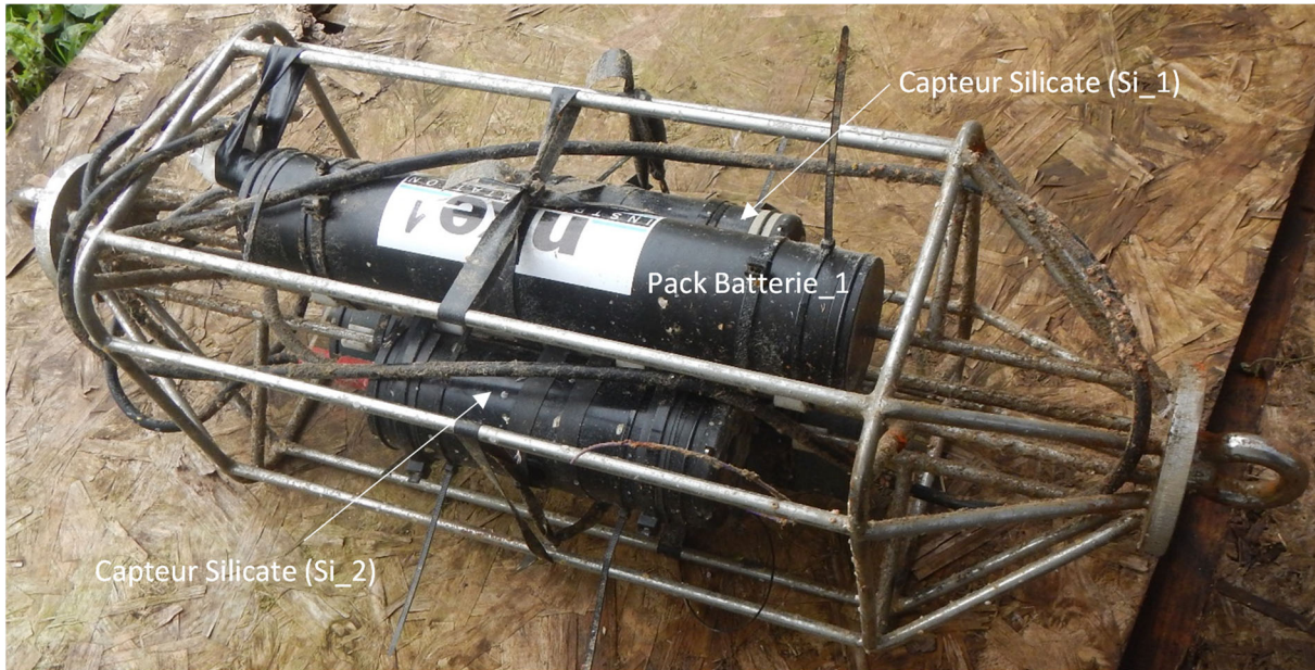
Figure II - 22 : Cage en acier inoxydable instrumentée de 2 capteurs Silicate et leur pack de batterie
