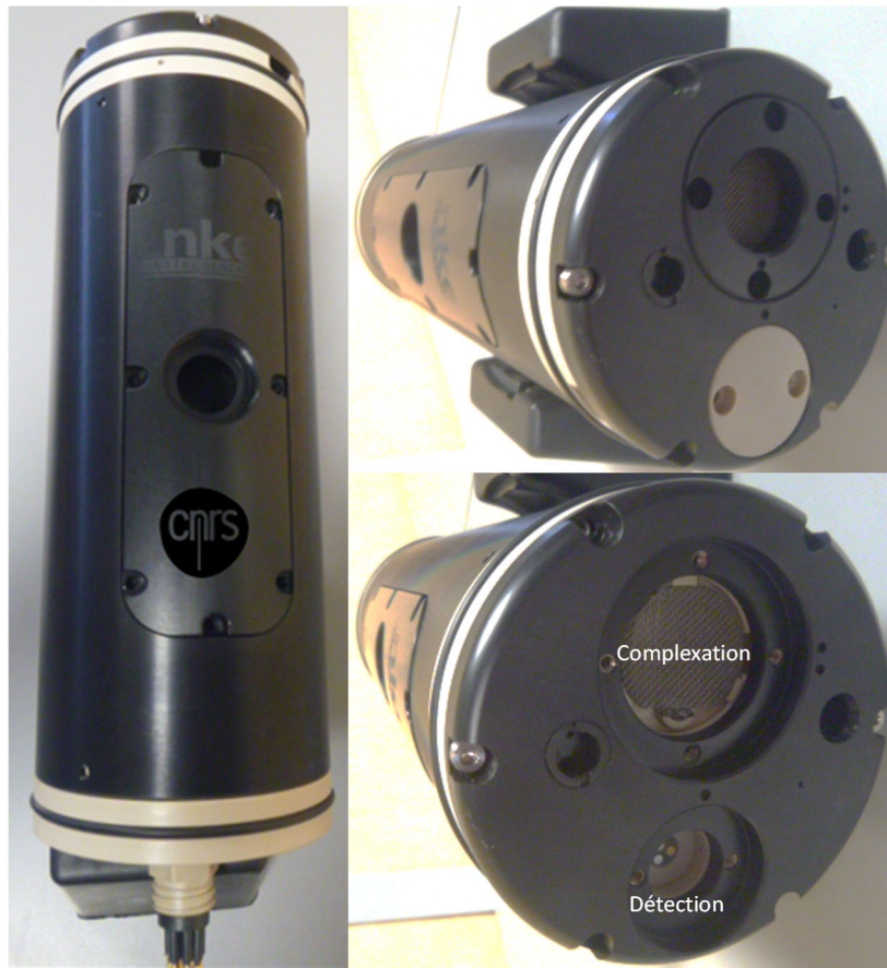
Figure II - 16 : Capteur électrochimique pour la détection in situ des silicates
