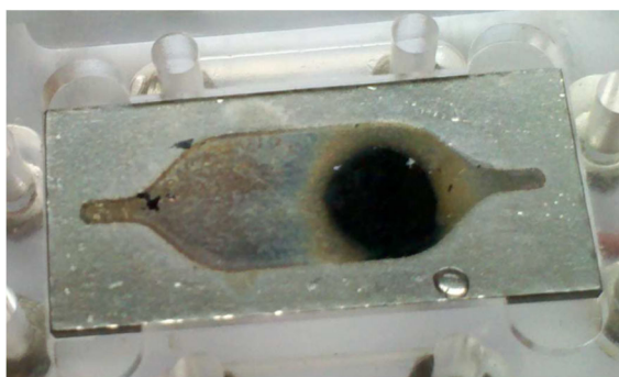
Figure II - 12 : Electrode de Mo après oxydation dans le prototype n°1 à cellule unique
