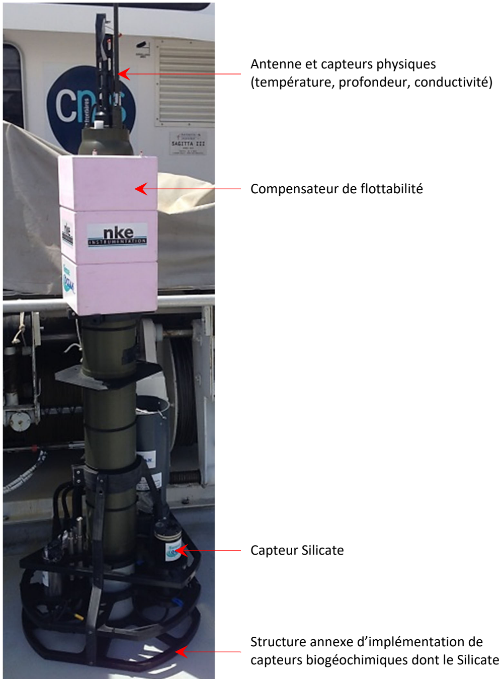
Figure II - 25 : Flotteur profileur PROVOR instrumenté du capteur Silicate
