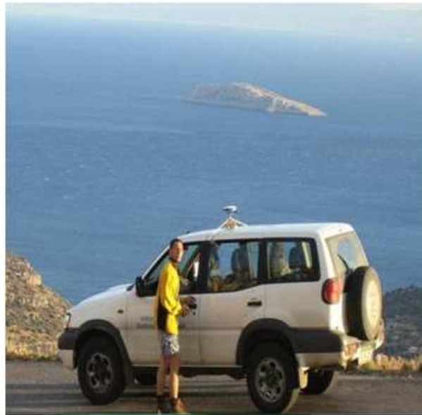
FIG. 4.1 – Le déplacement d'une antenne GPS sur un véhicule pour les mesures cinématique.
