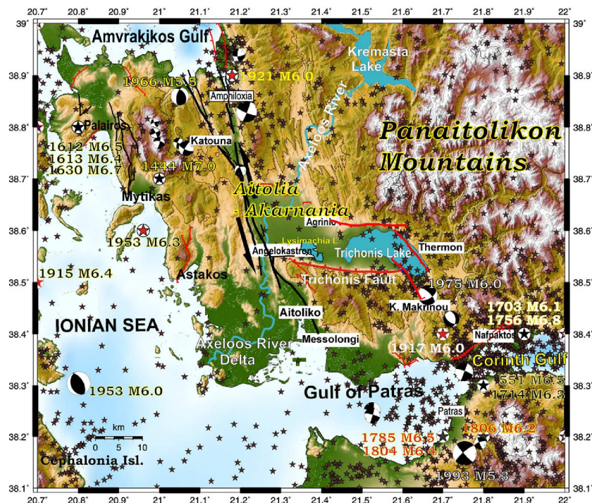
FIG. 3.10 – La situation du lac de Trichonis dans la région d’Etolie avec les séismes historiques et instrumentales enregistrés de magnitude > 6. Et les failles de décrochements (lignes noires et des flèches), qui relie le golfe de Patras et le golfe d’Amvrakikos., Kiratzi et al. [2008]
