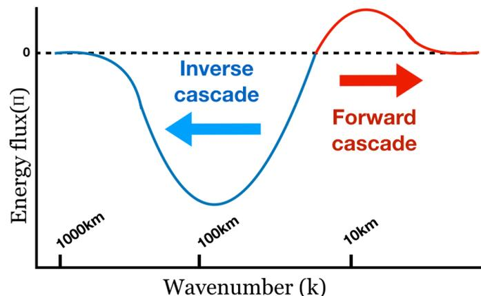
Figure 15: Schéma illustrant les flux inter-échelles d'énergie cinétique aux latitudes moyennes. en bleu : cascade inverse vers les grande échelles; Ren rouge : cascade directe vers les fines échelles. Les échelles spatiales sont indicatives.
