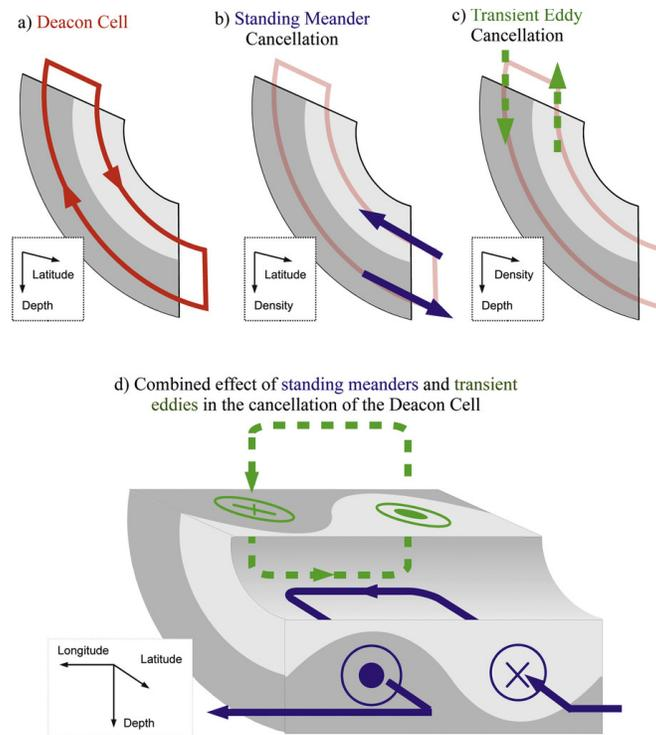
Figure 7: Schema illustrant les principales conclusions de [133] quant aux rôles respectifs des tourbillons transitoires (c) et des méandres quasi-stationnaire (b) de l'ACC dans la compensation de la circulation induite par le vent (a). Le schema (d) montre comment ces deux processus de compensation s'organisent en trois dimensions.
