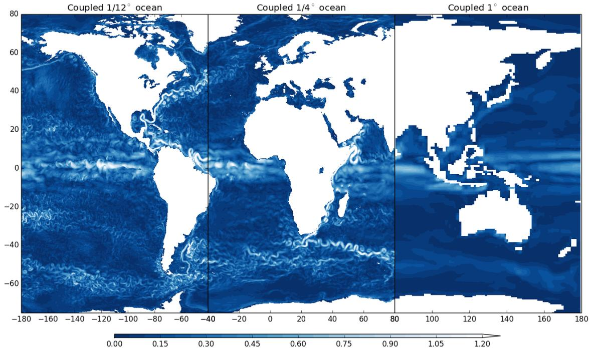
Figure 2: Intensité des courants océaniques de surface dans trois modèles océanique globaux couplés (atmosphère-océan/glace) basés sur NEMO à trois résolutions différentes - (à gauche) 25km-1/12 degrés, (au milieu) 60km-1/4 degrés, (à droite) 130km-1 degrés (crédit : Malcolm Roberts)
