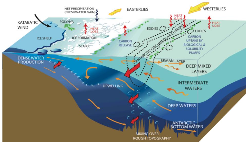
Figure 9: Schema représentant en coupe méridienne les principales masses d'eaux de l'océan austral, leur circulation ainsi que leurs interactions avec la glace de mer et la calotte glaciaire antarctique. Cette figure est reproduite de [153] et extraite du cours d'introduction à l'océanographie physique de Lynne Talley [154]
