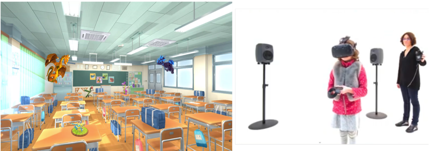
Figure 11 : Projet en RV de l'environnement immersif de rééducation de KidTrain. La salle de classe comportera des éléments visuels structurant (murs, plafond, tables, etc.) et des sources sonores potentielles (symbolisées par des dragons) dont une seule sera à l'origine de la voix à localiser (image de gauche). Cette source sonore réelle sera positionnée manuellement par l'expérimentateur en suivant la procédure SPHERE, d'autres haut-parleurs assureront de délivrer un bruit de fond (photo de droite) autour de l'enfant portant un casque de réalité virtuelle.
