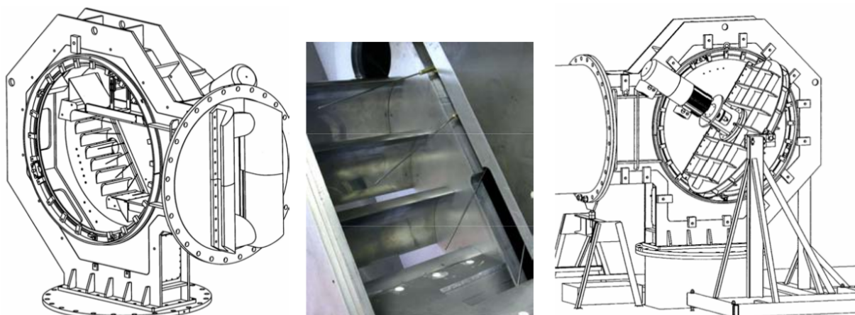
FIGURE 2.3 – Configuration expérimentale de la cascade T106C avec barreaux en rotations (de Arts et Houtermans [6])
