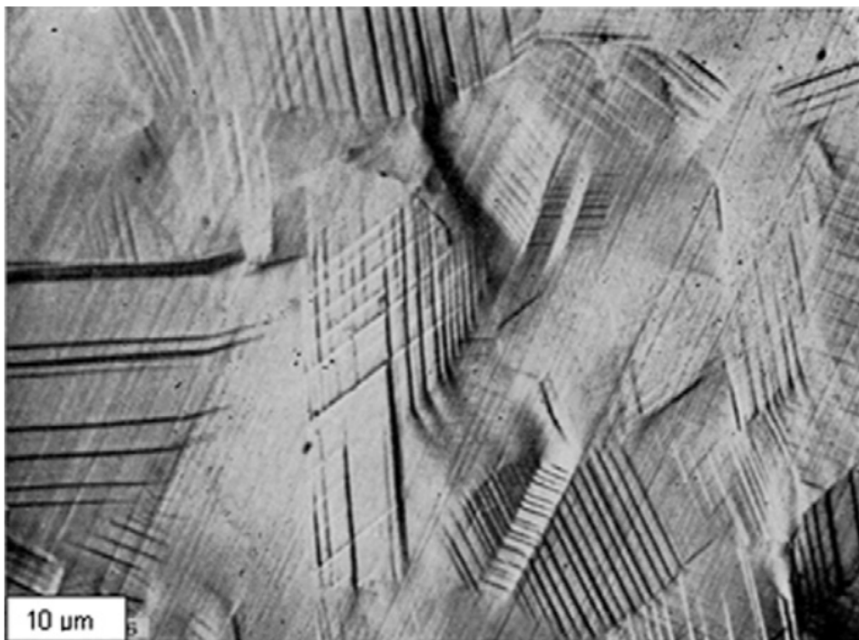
Figure 1.9 • Lignes de glissement pour un acier déformé à 35% [Colette et al., 1957]
