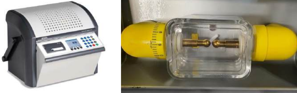
Figure 33 : Appareil Baur DPA 75 C (gauche) et cellule de test remplie de Galden HT55 lors du test de mesure de rigidité diélectrique (droite)
