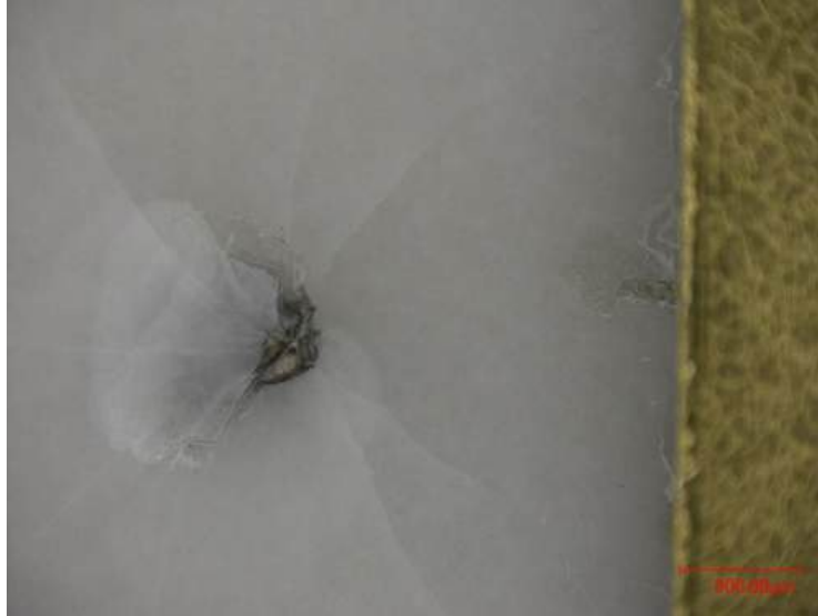
Figure 105 : Exemple d'un échantillon de la catégorie « point de rupture avec dommages larges et profonds », de 2 mm d'épaisseur - Rupture DC+ dans le gel silicone
