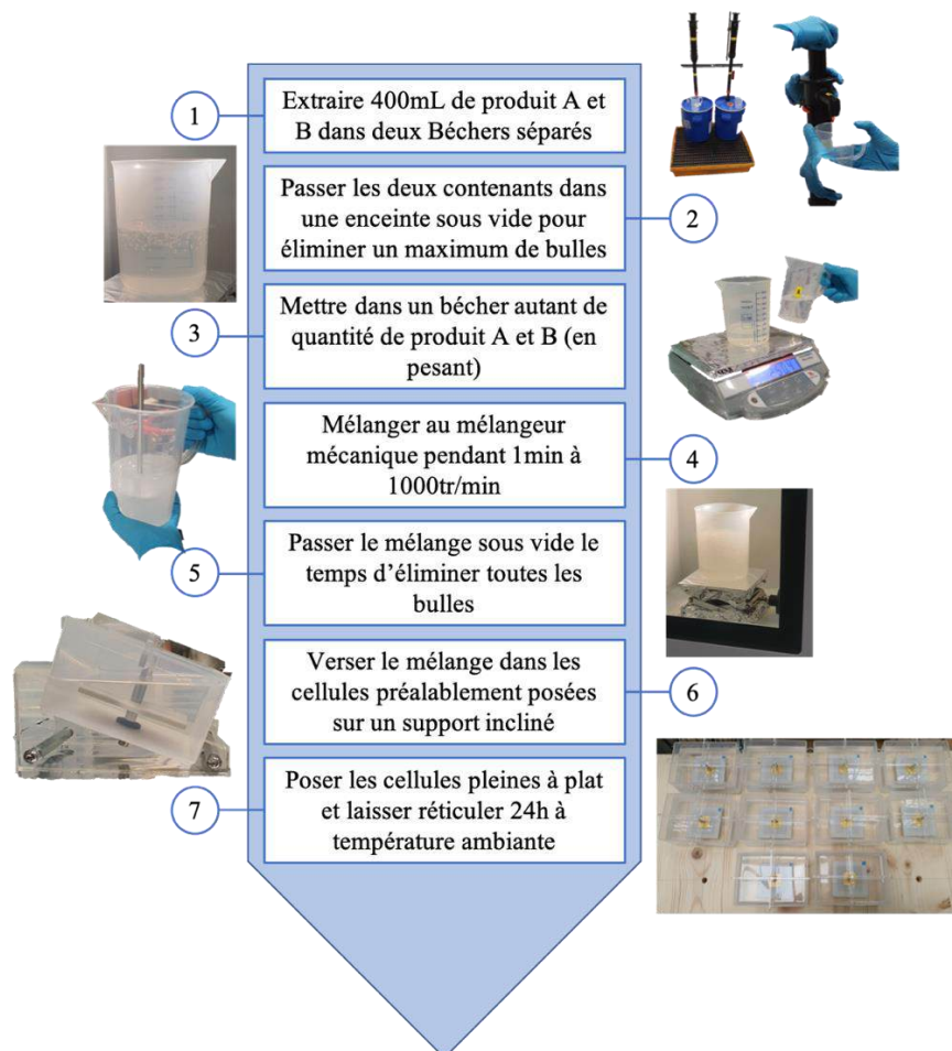
Figure 36 : Protocole d'encapsulation des échantillons dans du gel silicone
