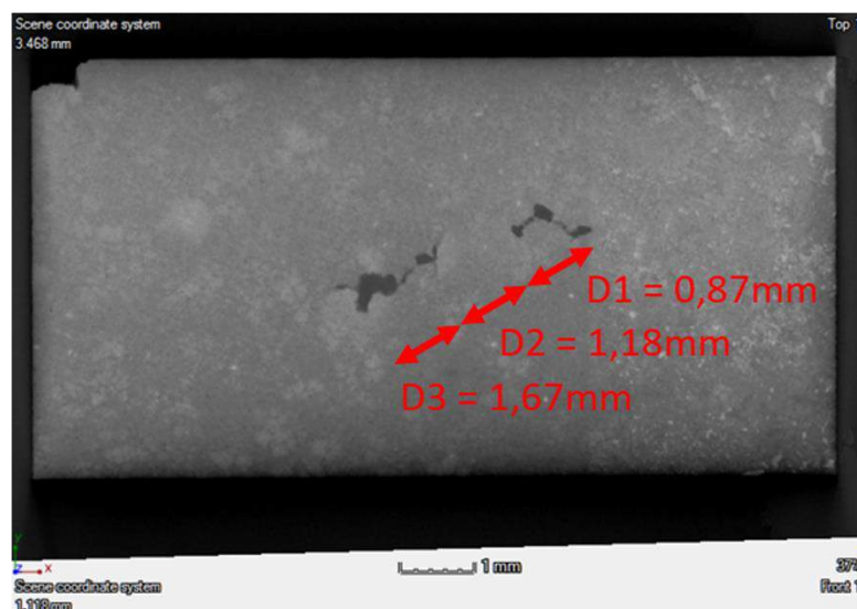
Figure 74 : Images obtenues par tomographie RX en vue de dessus de la face supérieure
