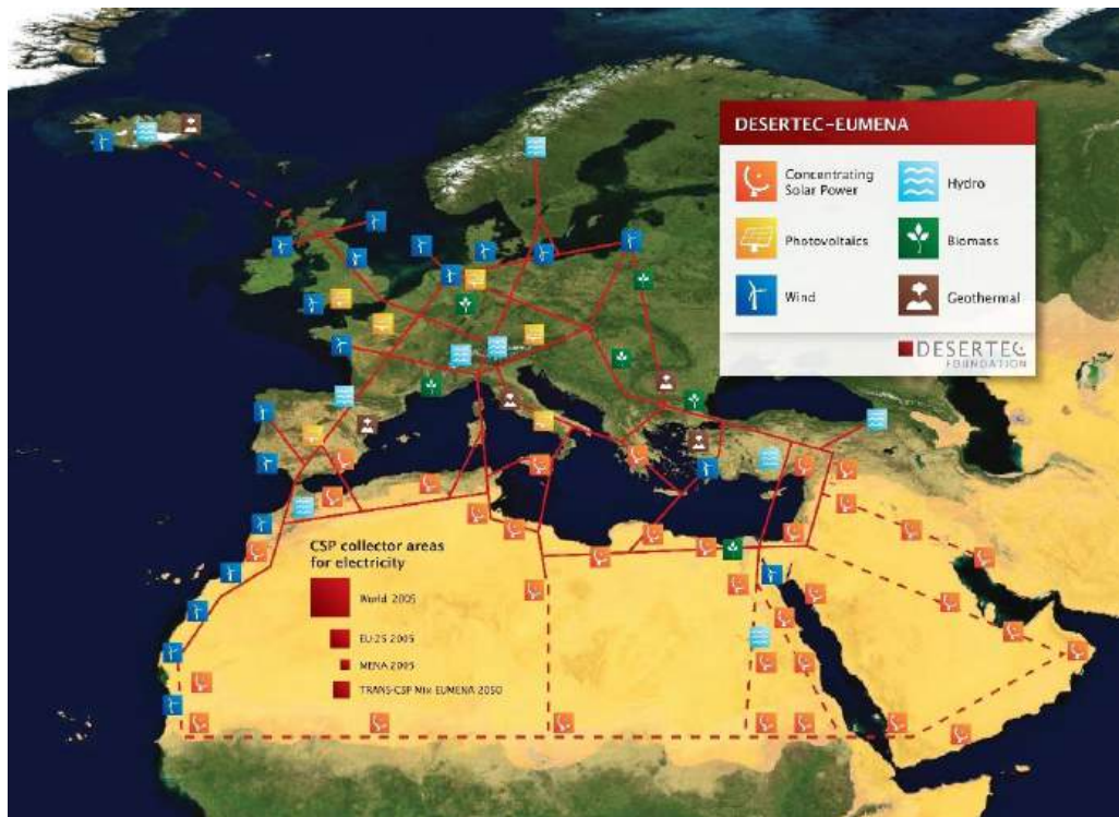
Figure 3 : Esquisse du réseau électrique nécessaire au projet Desertec pour que l'Afrique du Nord et le Moyen-Orient puissent alimenter l'Europe en électricité issue de l'énergie solaire, soulignant l'éloignement entre lieux de production d'énergie renouvelable et lieux de consommation [7]
