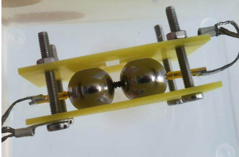
Figure A1-2 : Photographie d'un échantillon prise après la rupture AC 50 Hz
