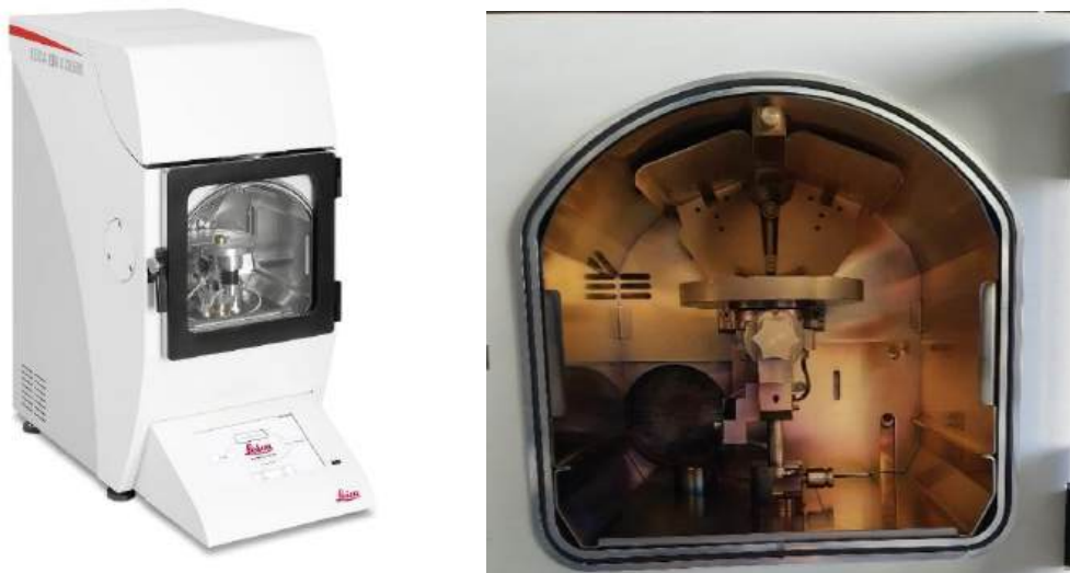
Figure 30 : Appareil EM AC600 de chez Leica, adapté pour la pulvérisation d'une couche de 120 nm d'or sous vide sur des céramiques en AlN
