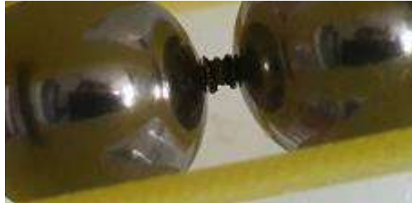
Figure A1-2 : Photographie d'un échantillon prise après la rupture AC 50 Hz du gel entre deux électrodes sphériques
