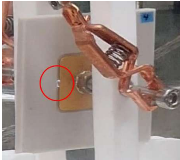
Figure 131 : Streamer en bord de métallisation d'un substrat RoME plongé dans le liquide diélectrique
