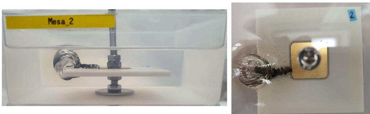
Figure 144 : Photographies de profil et de dessus d'un substrat Mesa encapsulé dans du gel silicone après la rupture
