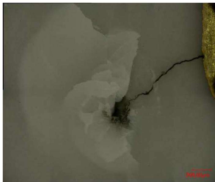
Figure 108 : Exemple d'un échantillon de catégorie « fracture large et assez profonde », de 1 mm d'épaisseur - Rupture DC+ dans le liquide diélectrique
