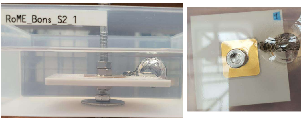
Figure 129 : Photographies d'un substrat RoME encapsulé dans du gel silicone après la rupture
