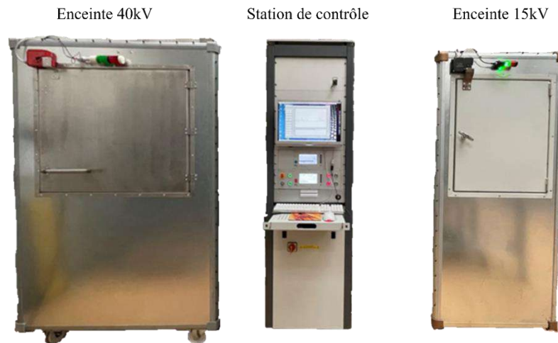
Figure 42 : Les deux enceintes utilisées pour la mesure de décharges partielles et la station de contrôle commune
