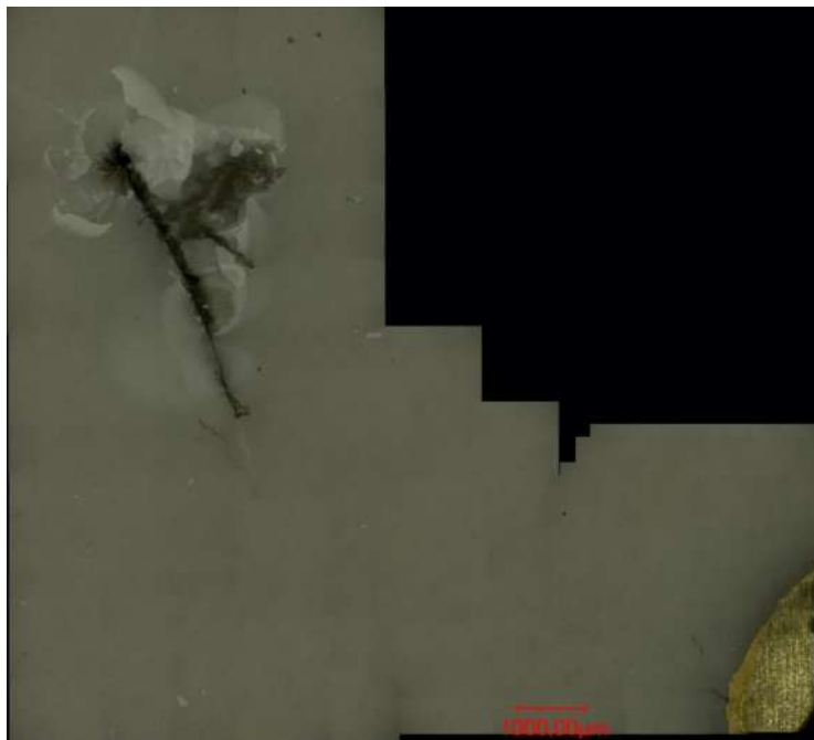
Figure 106 : Exemple d'un échantillon de la catégorie « point de rupture avec dommages très importants », de 3 mm d'épaisseur - Rupture DC+ dans le liquide diélectrique
