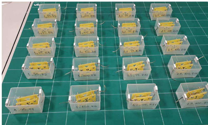
Figure A1-1 : Cellules de tests assemblées, prêtes à être encapsulées
