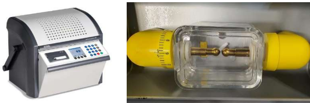
Figure 33 : Appareil Baur DPA 75 C (gauche) et cellule de test remplie de Galden HT55 lors du test de mesure de rigidité diélectrique (droite)
