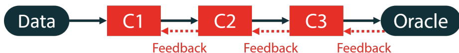
FIGURE 3.1 – Schéma d'un modèle connexionniste dans lequel trois classifieurs C1 , C2 et C3 sont chaînés.
