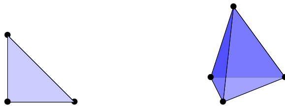
Figure 1 – Représentation d'un élément de maillage triangulaire en 2D et d'un élément de maillage tétraédrique en 3D.
