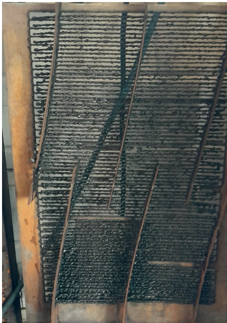
Figure 93: Tôle d'acier découpée lors d'un essai d'usure
