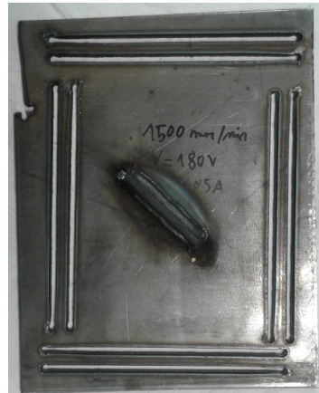
Figure 87: Eprouvette avec prise soudée et saignées
