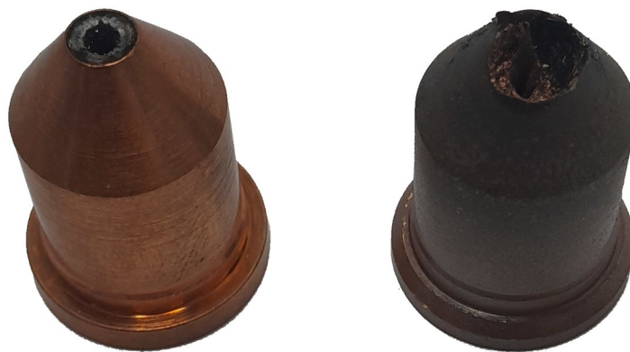
Figure 92: Tuyères fonctionnelle (gauche) et détruite (droite)
