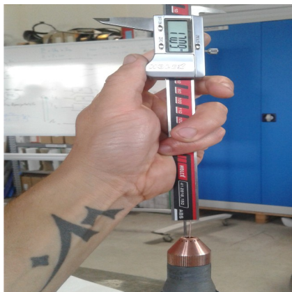
Figure 34: Mesure de la rétractation de l'électrode à l'aide d'un pied à coulisse numérique et d'un fil rigide inséré dans la tuyère. La torche est branchée au poste en mode test d'air.
