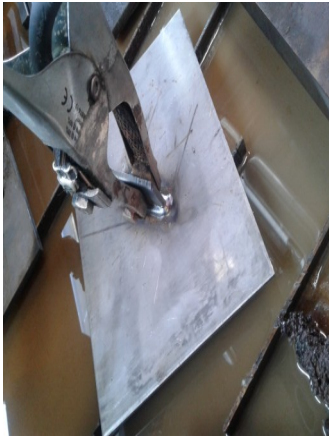
Figure 86: Eprouvette avec prise pour la pince de masse soudée au milieu
