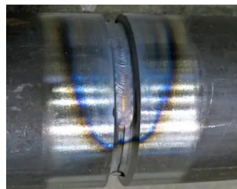
Figure 11: Pièces soudées avec coloration provoquée par l'échauffement
