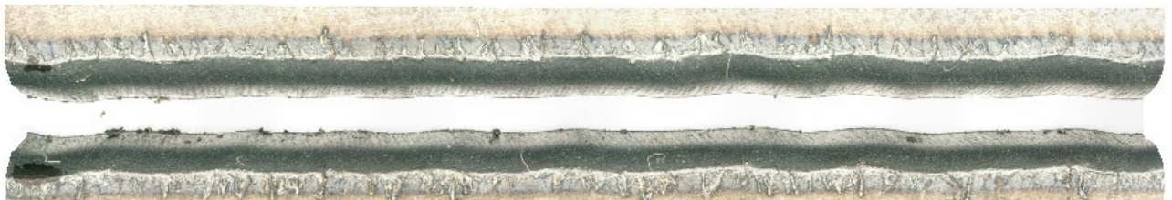
Figure 68: Vue de dessus d'une saignée au microscope, composition d'images en zoom \times 20
