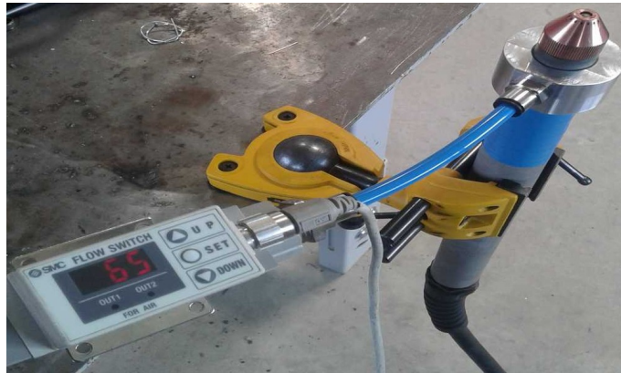
Figure 38: Torche en test d'air équipée de la bague de débit arrière. Le débit est canalisé dans le tuyau bleu et mesuré par le débitmètre à gauche de l'image
