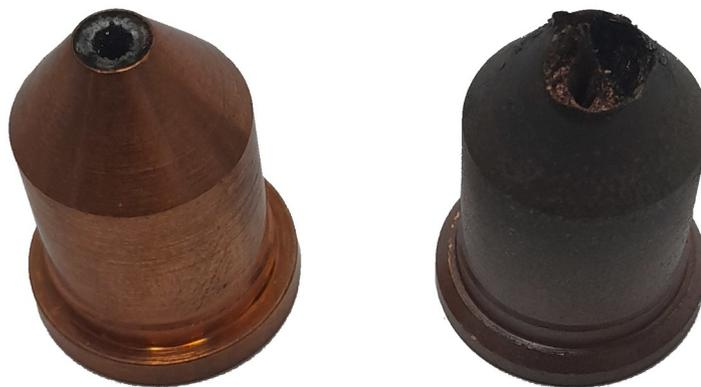
Figure 92: Tuyères fonctionnelle (gauche) et détruite (droite)
