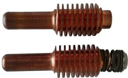
Figure 23: Electrodes TopArc (en haut) et Hypertherm (en bas)
