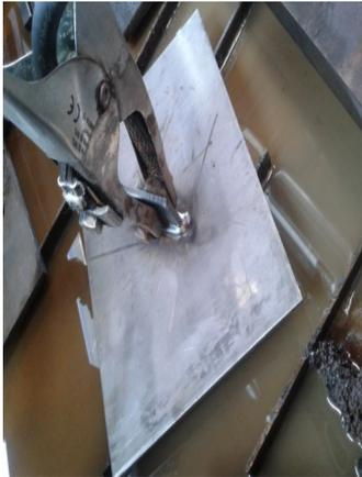
Figure 86: Eprouvette avec prise pour la pince de masse soudée au milieu
