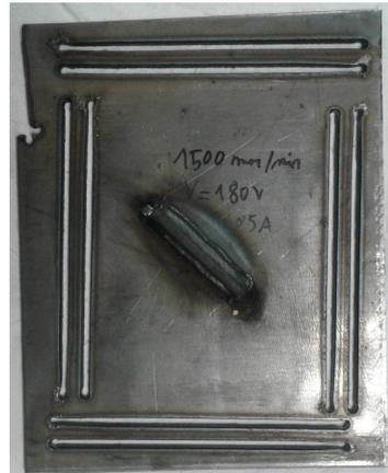
Figure 87: Eprouvette avec prise soudée et saignées
