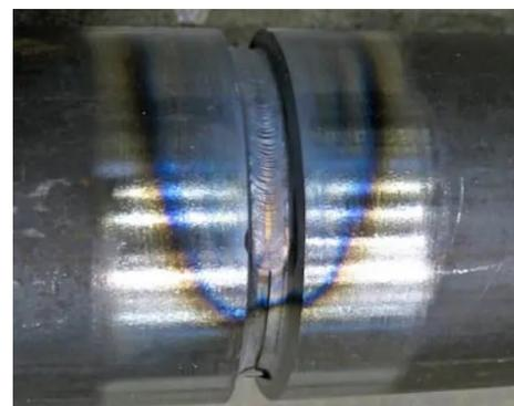
Figure 11: Pièces soudées avec coloration provoquée par l'échauffement
