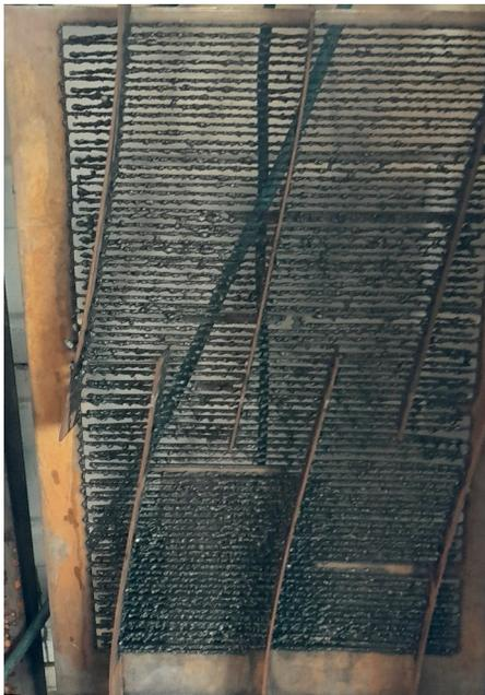
Figure 93: Tôle d'acier découpée lors d'un essai d'usure
