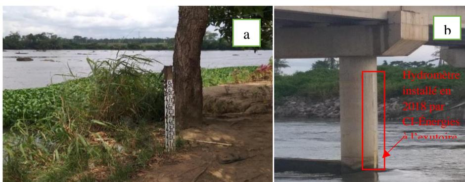
**Photo 12 :** Limnimètres à l'exutoire du bassin versant du fleuve Sassandra à Soubré datant de 1958 (**a**) et 2018 (**b**) (Source cliché : Kouamé K., 2021)
