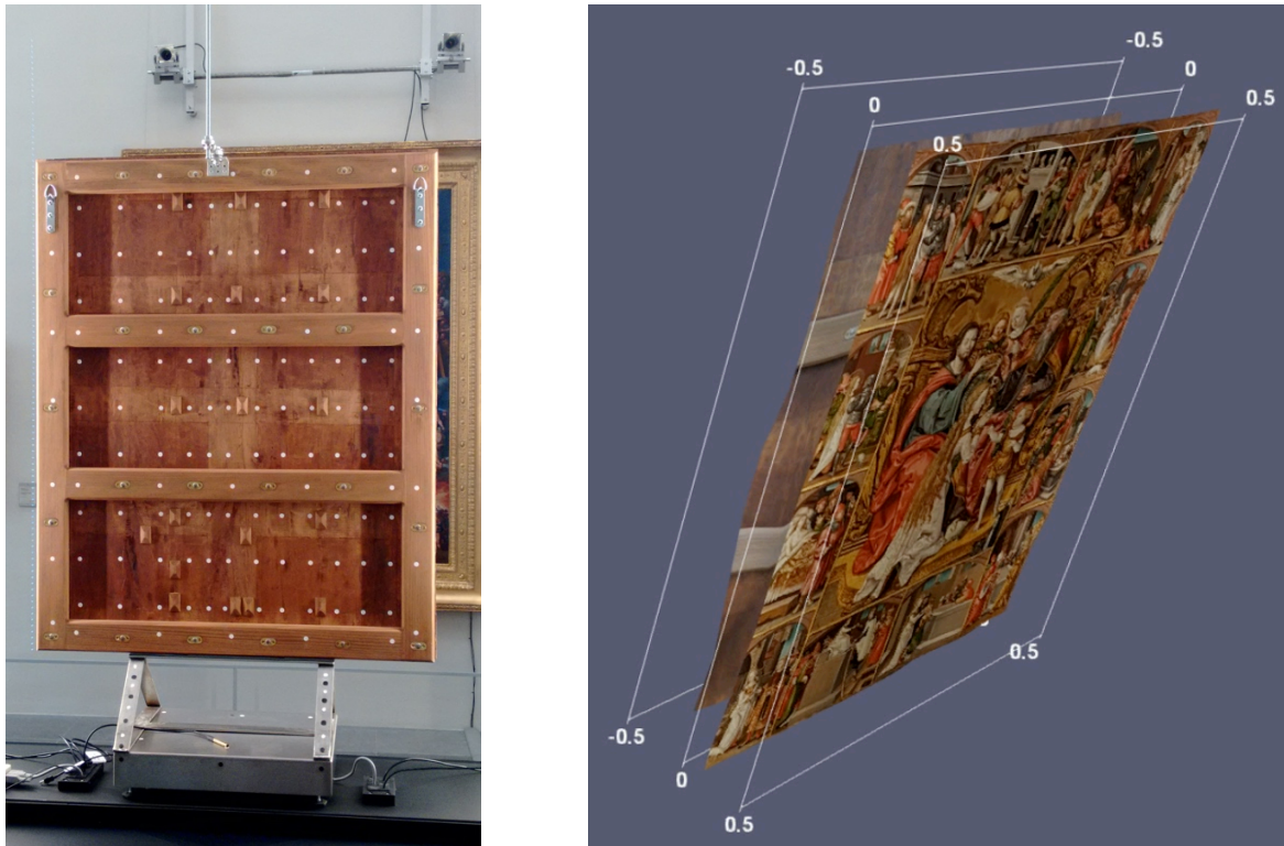
Figure 66 : « Sainte Agnès » et son châssis avec marqueurs au dos (à gauche). Relief suivi au cours du temps par stéréo-corrélation (à droite).
