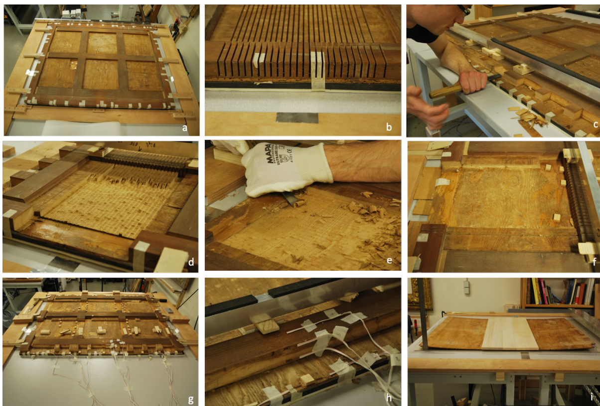
Figure 86 : Restauration : a) Après élimination des placages, incision entre les traverses b) Incisions dans le renfort arrêtées à 2mm du panneau c-f) enlèvement de matière à l'aide d'une gouge g-h) Positionnement de jauges de déformations i) Mise en place du doublage balsa
