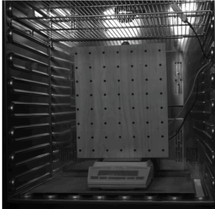
FIGURE 3.3 – Photo du panneau dans l'enceinte climatique sur la balance interfacée.
