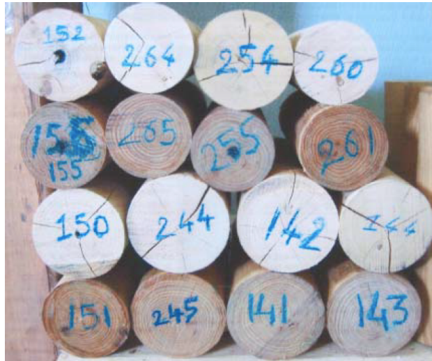
Figure 22 : Billons appariés après traitement oléothermique puis séchage (numéros impairs) ou séchage naturel (numéros pairs) [60]
