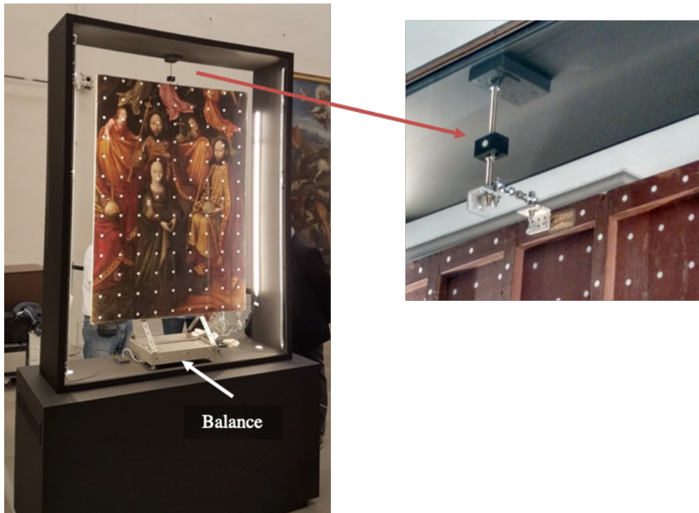
Figure 45 : Vitrine climatisée et système de positionnement vertical
