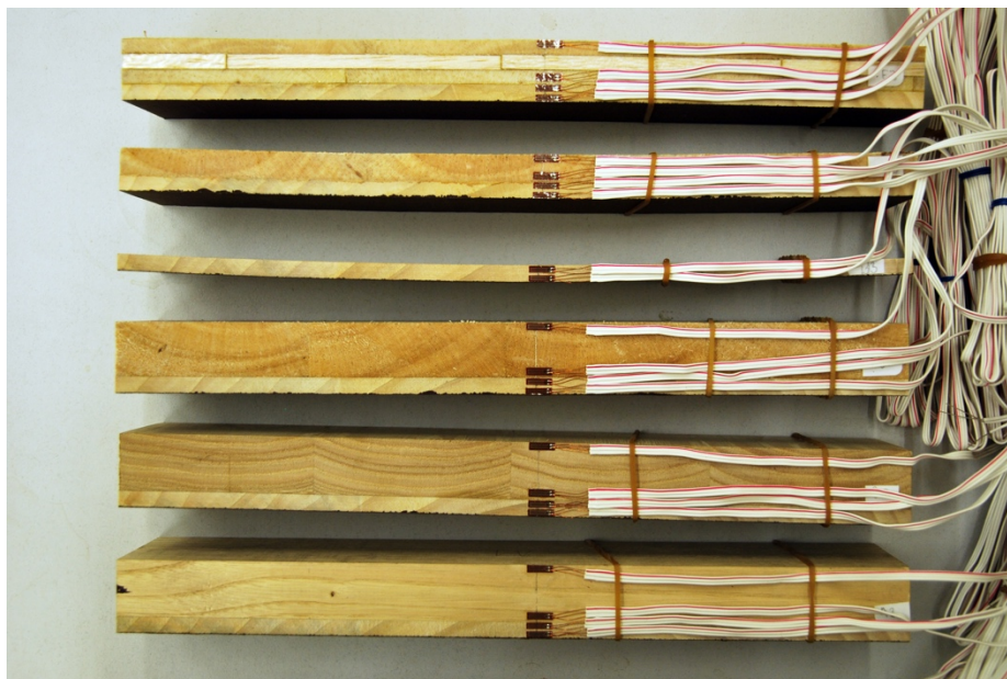
Figure 75 : Échantillons munis de jauges de déformation : 2 sur le renfort, 2 sur le panneau, 1 (non visible) sur chaque face peinte, 1 (non visible) sur la face non peinte du panneau sans renfort [106]
