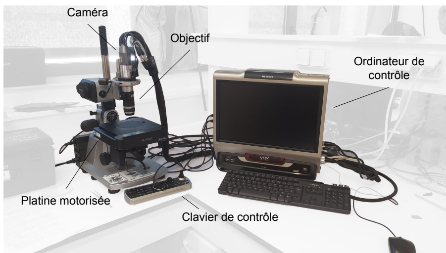
FIGURE 2.9 – Photo légendée du microscope numérique Keyence VHX-2000 utilisé dans l'acquisition d'images de grains issus de nos échantillons glacés.
