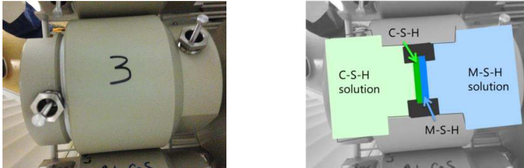
Figure 54 – Photographies des montages expérimentaux permettant de générer des interfaces C-S-H/M-S-H en conditions saturées à 25°C. Sur la photographie de droite est superposé un schéma représentant le principe de l'essai (Bernard et al., in review).
