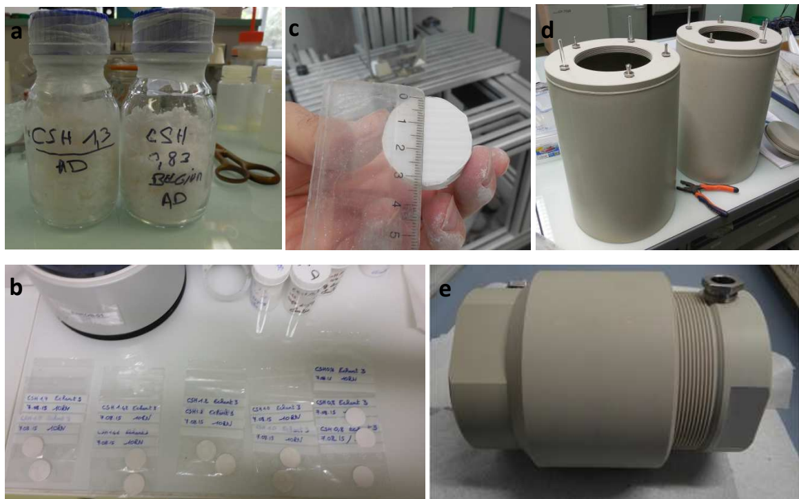
Figure 60 – Préparation des essais expérimentaux : a) Gels C-S-H après synthèse b) pastilles de C-S-H après compaction ; c) pâte de C3S après découpe du matériau hydraté 3 mois ; d) Réservoirs de solutions d'attaque pour les essais de dégradation des pâtes de C3S ; e) cellule de diffusion pour mesurer les propriétés de transfert des C-S-H et de la pâte de C3S avant et après altération dans les solutions d'attaque.
