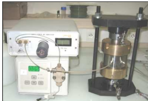
Figure 43 – Dispositif expérimental utilisé pour générer des interfaces fer/argile en conditions réductrices (Chautard, 2013).
