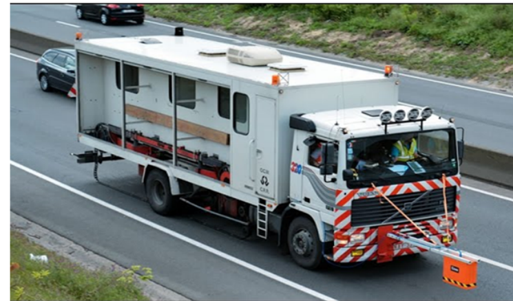
D : Curvimètre (Constant-move nature)
